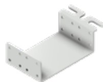
Liitos- ja kannatinkappale Kappaleeseen voidaan kiinnittää 10 tai 12 mm:n kierretanko
