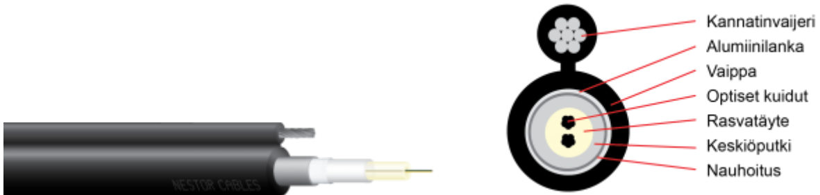
Kuva 1 FYOHBMUK kaapelirakenne
