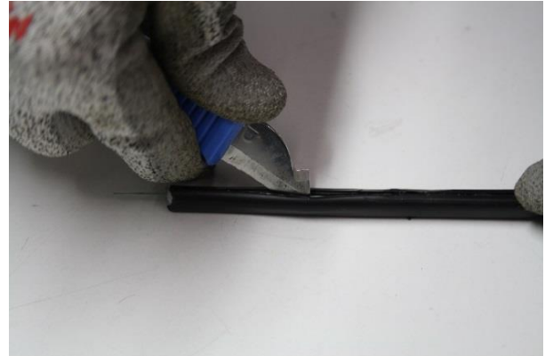
Kaapelin päässä halkaistaan vaippa teräslankojen urien kohdalta noin 10 cm:n pituudelta.
